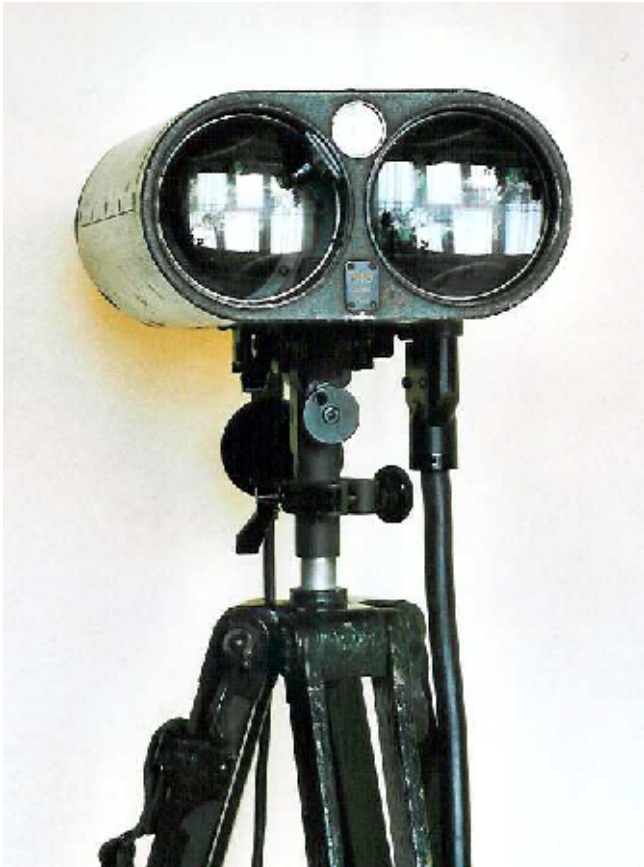
Sender-Empfänger des Lichtsprechgerätes Li Spr 80 auf dem Gestell, betriebsbereit, Baujahr 1940
