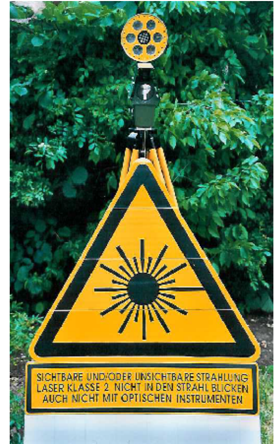
Zum Lichtsprechgerät umgebaute Lichtschranke mit aufgesetzter Bake, Tripelprismen und LED-Blitzgerät von 1999
