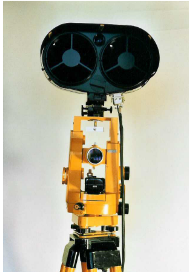
Lichtsprechgerät JO 4.02 und THEO 015B von CARL ZEISS JENA, Baujahr 1985/1978
